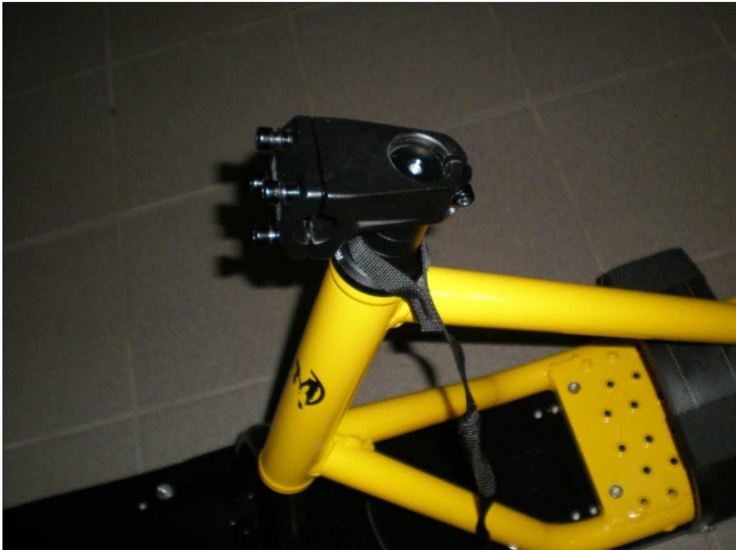
10. Serrez la vis de la rondelle d'arrêt pour régler le jeu de la colonne de direction la fourche doit tourner librement
